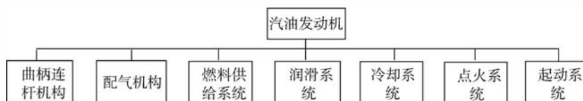
图 1-1-1 发动机的基本组成
