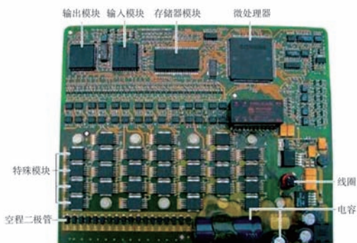
图 2-4 CAN 控制器电路
