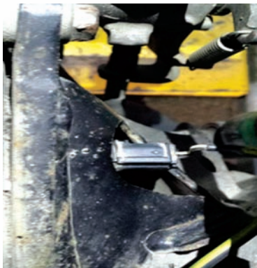
图 3-6 后轮转速传感器安装位置
