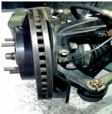
图 3-4 前轮转速传感器安装位置
