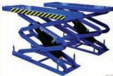
(3) 剪式举升机。执行部分采用剪式叠杆形式，电力驱动机械传动结构，目前广泛用于各类车辆的维修。剪式举升机的举升速度适中且不占用车坑位置，对于一些车型相对固定、工作强度大（如公共汽车）的修理领域无疑是最好的选择。而且由于结构简单、同步性好，一般常用作四轮定位仪的平台。剪式举升机分为大剪（子母式），举升机、小剪（单剪）举升机、超薄系列剪式举升机等几种类型
