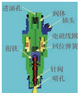
图 2-42 喷油器的结构
