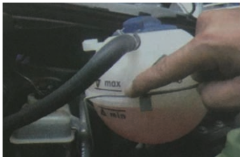
图 1-12 检查冷却液液面
