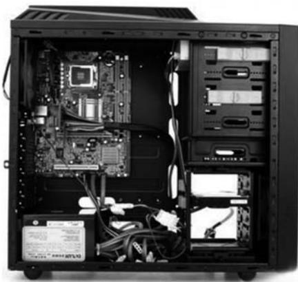
图 1-2-5 主机箱内部结构图
