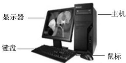
图 1-2-2 计算机的外观结构
